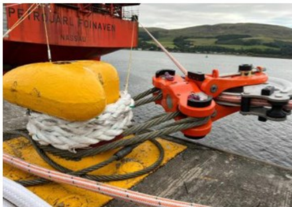
Figuur 3-8 Bevestiging van katrol aan bolder
